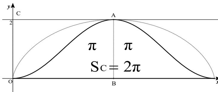
まず左側は、タイヤの回転位置のすべてにおいて、すべての垂線PHの長さは、円周から直径に降ろしたすべての垂線の長さに等しい。したがって、左側の面積の差は半円の面積に等しい。右側も同様なので、左右合計で $\pi$ となる。
