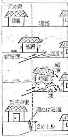
蒲郡市金平町にできた断層の模式図
